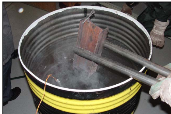
Figura 3.11 – Sistema de arrefecimento forçado.
