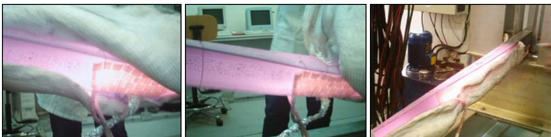
Figura 4.21 – Viga na fase final do ensaio.
