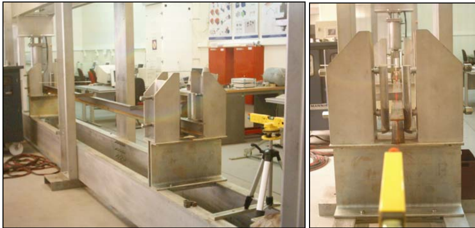
Figura 4.9 – Feixe laser para medição das imperfeições.
