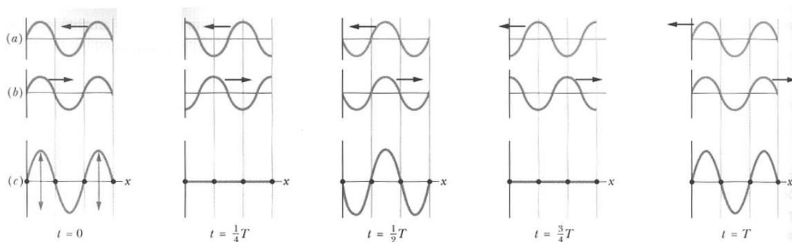
Os padrões aqui representados denominam-se ondas estacionárias, pois esses padrões não se deslocam, quer para a esquerda, quer para a direita: os locais onde ocorrem os mínimos e os máximos são sempre os mesmos. Conclusão: sempre que duas ondas sinusoidais com a mesma amplitude e com o mesmo comprimento de onda viajam em direcções opostas ao longo de uma corda esticada, a sua sobreposição origina uma onda estacionária.
