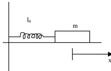
A mola tem comprimento livre  $l_0$  e uma constante de rigidez  $k$ . Marque-se um eixo dos  $xx$  com origem na posição da massa quando a mola está com o seu comprimento igual ao comprimento livre, isto é, em repouso.
