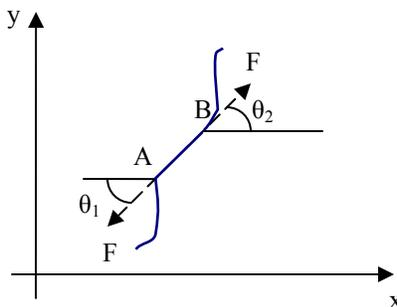
A força que as partes da corda não representadas exercem, à esquerda e à direita do troço que está a ser analisado, só pode ser tangente ao troço, porque uma corda flexível como a considerada só transmite força de tracção – a força de tracção  $F$ .
