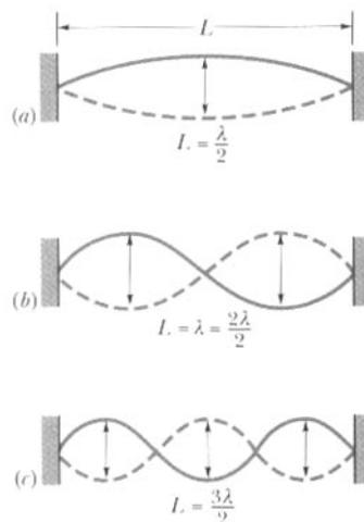
No caso da alínea b), tem-se três nós (um em cada extremo e um terceiro nó a meio da corda) e dois anti-nós (diz-se formar um padrão de dois anéis). Para que as ondas que
