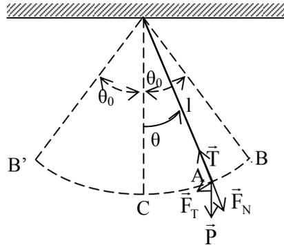
A partícula move-se ao longo de um arco com raio  $l = OA$ . As forças que actuam na partícula são o peso,  $\vec{P}$ , e a tensão no fio,  $\vec{T}$ . Como o fio tem comprimento fixo, é fácil de deduzir que a componente normal do peso é anulada, a cada instante, pela tensão no fio. A componente tangencial resultante é dada por
