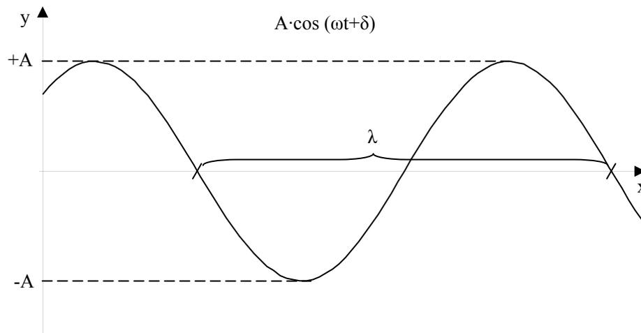
A distância entre dois pontos que instantaneamente têm o mesmo valor de onda chama-se comprimento de onda,  $\lambda$ . Na figura está representada a distância entre dois pontos em que o valor é zero. Matematicamente, é, para um mesmo instante  $t$ , e para o argumento  $x - vt$ ,
