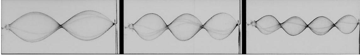
Cada uma das ondas estacionárias é produzida em ressonância e a corda está ressonante a estas frequências, denominadas frequências de ressonância. Se a corda vibrar a uma frequência diferente de uma das frequências de ressonância, não se gera uma onda estacionária e a sobreposição de ondas viajando da esquerda para a direita e no sentido oposto produzirá apenas pequenas vibrações da corda.
